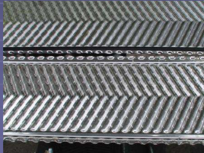
Ламели полностью очищены от отложений водного камня, ржавчины и загрязнения.
